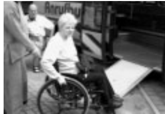
Gepüßt... und für zu schmal befunden. Die Rampe an dem Niederflerbus ist zu schmal für einen breiten Rollstuhl. So kommt Herr Banz nicht in den Bus.
