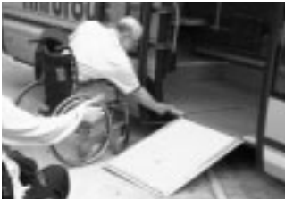
Gepüßt... und für zu schmal befunden. Die Rampe an dem Niederflerbus ist zu schmal für einen breiten Rollstuhl. So kommt Herr Banz nicht in den Bus.
